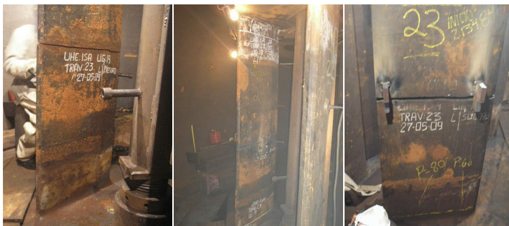
Figura 8: Trincas detectadas em 9 travessas da UG 19 (6 seccionadas) durante parada para manutenção em Dezembro de 2012. Fonte: CESP.
