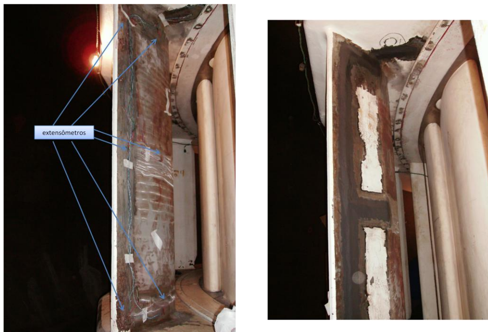
Figura 13: Extensômetros fixados na travessa. Fonte:CESP.
